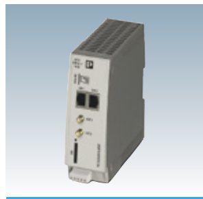
Dálková správa- TC CLOUD CLIENT přes LAN a mobilní síť
